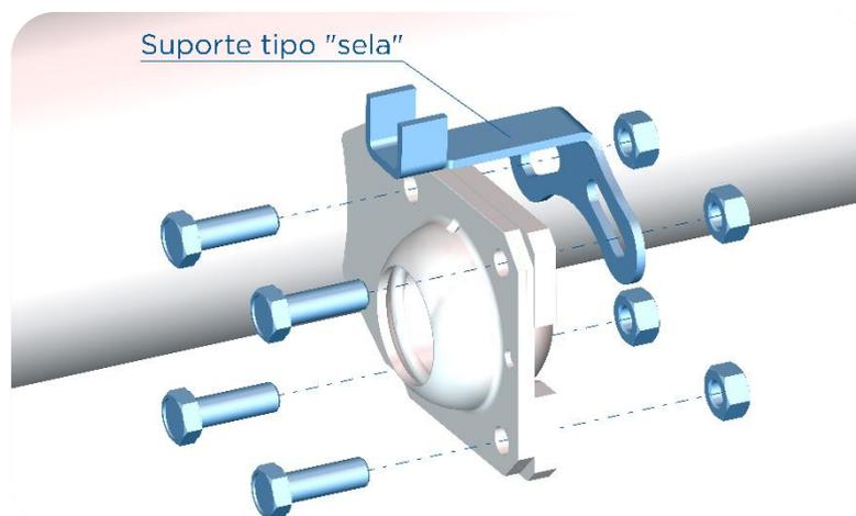
7] Puxe a tampa oposta ao suporte do mancal (tampa macho) com cuidado para não ocorrer a queda dos componentes internos do mancal. Posteriormente, retire a bucha polimérica de desgaste e osq anéis *o'rings*.
