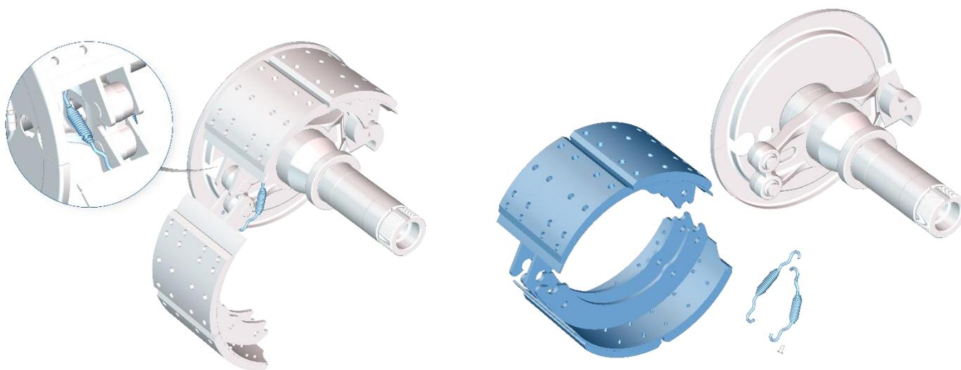
Neste ponto, pode ser realizada a retirada das lonas de freio por meio da remoção dos rebites na parte inferior (interna) das sapatas de freio. Utilize uma espátula para auxiliar na remoção e tenha cautela na manipulação para não ocasionar deformações nas sapatas.
